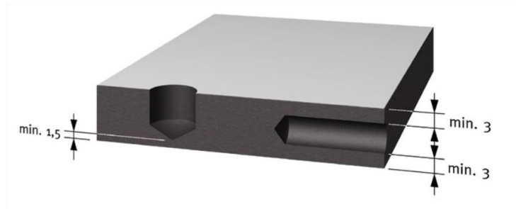
5 paveikslas. Minimalūs atstumai nuo gręžtinių skylių iki plokštės krašto
