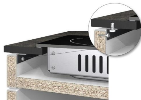
51 paveikslas.: Stabilizavimas metalinio skersinio pagalba
