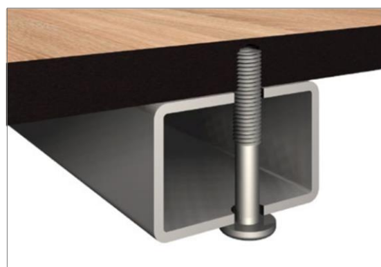
40 paveikslas. Rekomenduojamas kompaktinio stalviršio tvirtinimas
